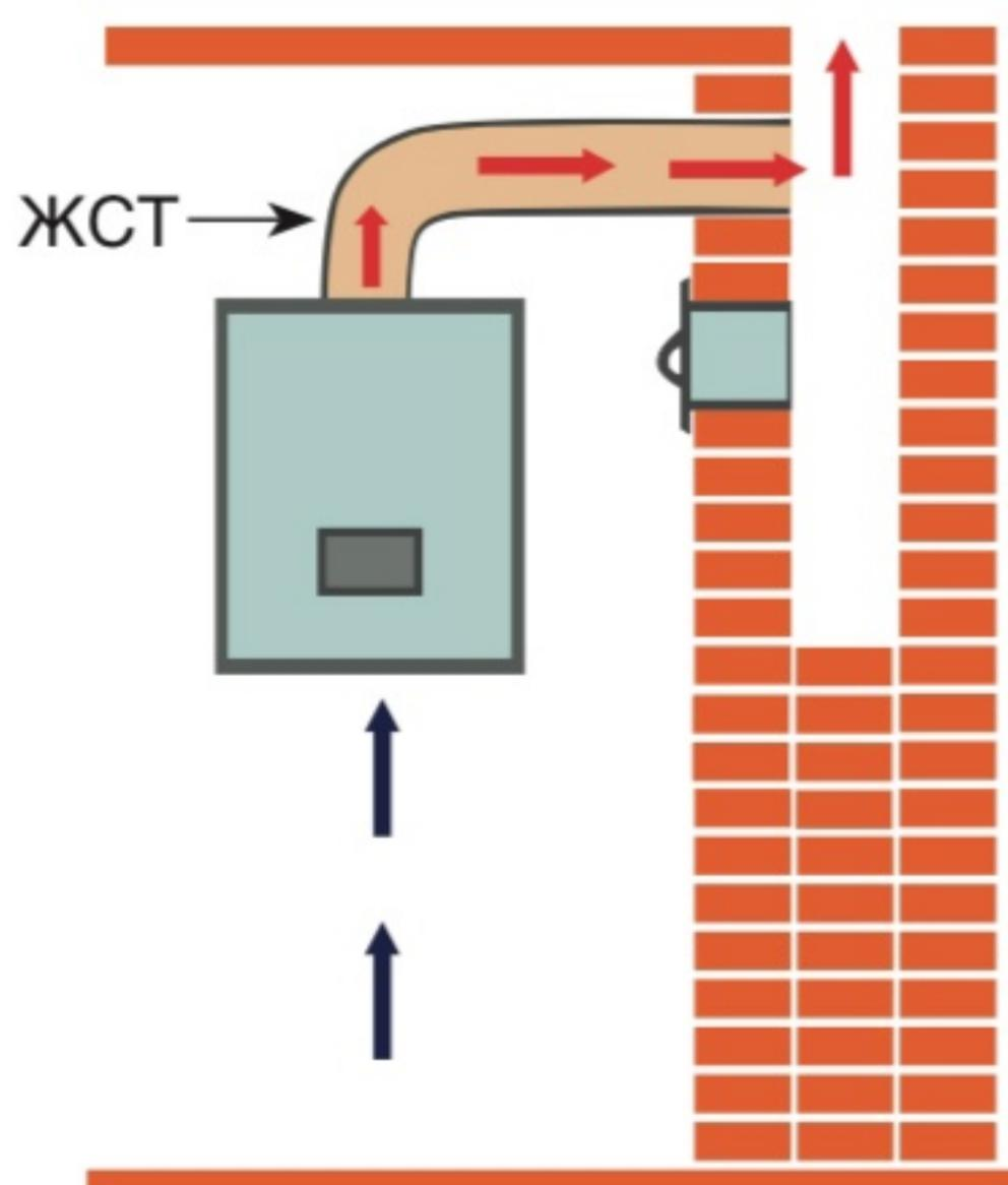
**ЖЕЛЕЗНО-СОЕДИНИТЕЛЬНЫЕ ТРУБЫ (ЖСТ) для отводов продуктов сгорания в дымоход**
