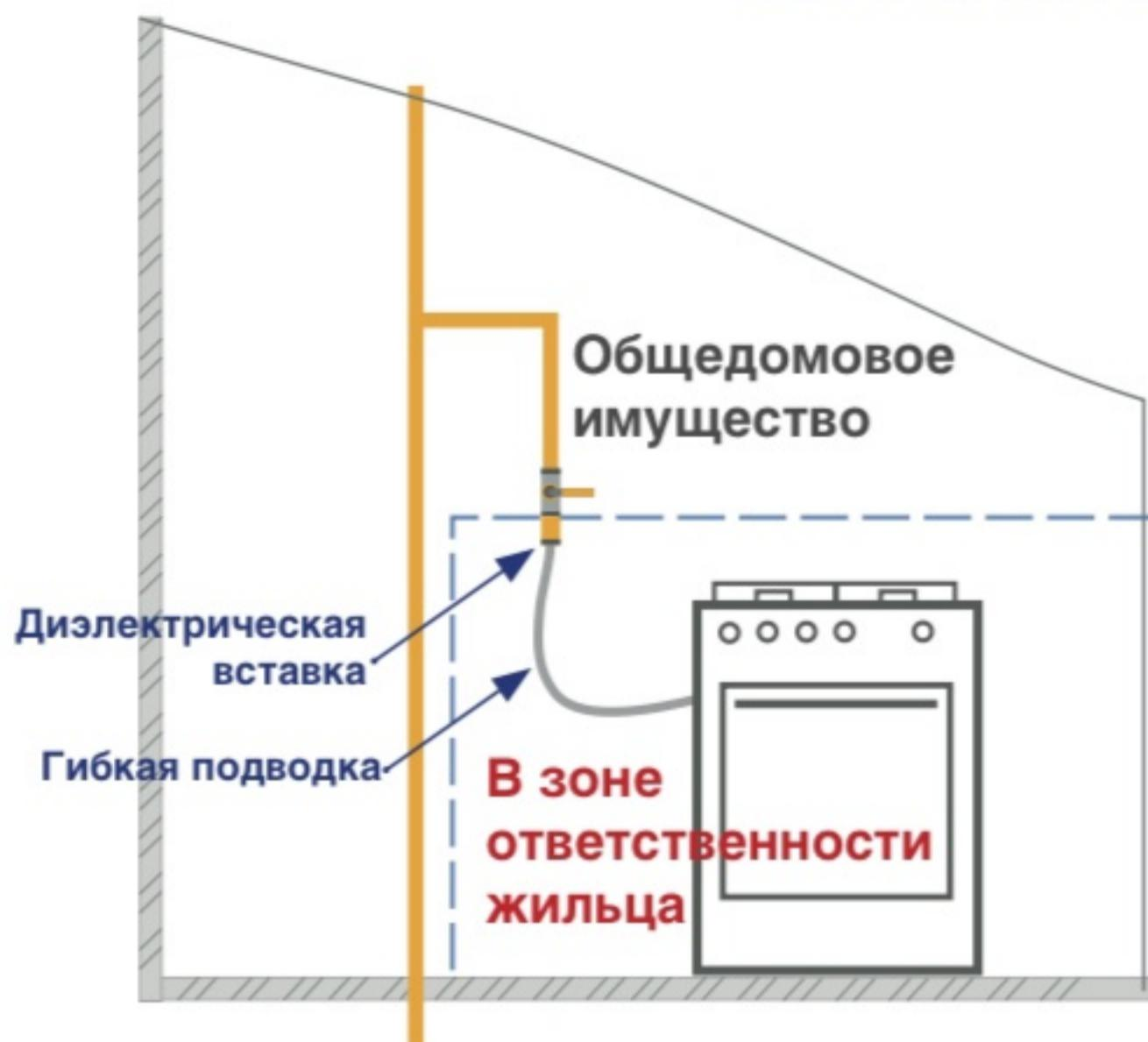
**Внутридомовое газовое оборудование (ВДГО)** – газопровод, проложенный внутри здания от места его первичного пересечения конструкций здания до запорного крана (отключающего устройства) перед газовым прибором, включая само отключающее устройство.
